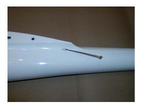
Nachdem Sie die Arretierung im Haubenrahmen hergestellt haben, gilt es die Kabinenhaube mit dem Rahmen zu verkleben. Passen Sie die Klarsichthaube an den Haubenrahmen mit etwas überstand an, und verkleben sie diese. Aufgrund seiner gut spaltfüllenden Eigenschaften bietet sich auch eingedicktes Epoxidharz zur Verklebung an. Sie schaffen dadurch einen sauberen Übergang zur Rumpfkontur. Nach dem Aushärten wird der Überstand vorsichtig beschnitten und passgenau verschliffen.
