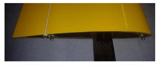
Bitte achten Sie darauf, dass der "V-Form-Knick" des Flächenverbinders bei an den Rumpf angesteckten Flächen in der Rumpfmitte ist, sonst haben Sie nicht auf beiden Flächen die gleiche V-Form!
