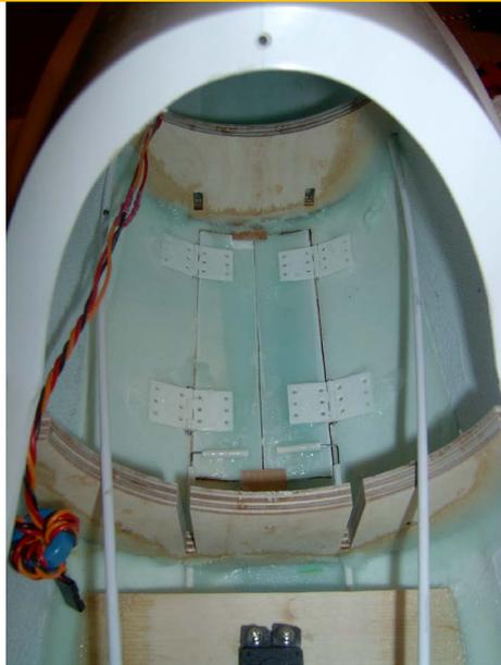
Wenn Sie kein Einzeifahrwerk installieren können Sie die beiden Spanten dennoch verwenden, da diese die Druckfestigkeit des Rumpfes weiter erhöhen.
